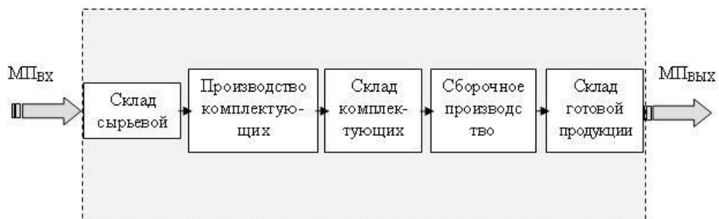
Рис. 2. Схема перемещения материального потока в границах внутрипроизводственной системы
